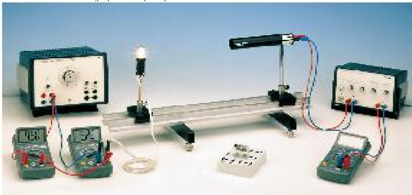
Fot. 1. Układ do doświadczalnego sprawdzenia prawa promieniowania Stefana – Boltzmannna.
