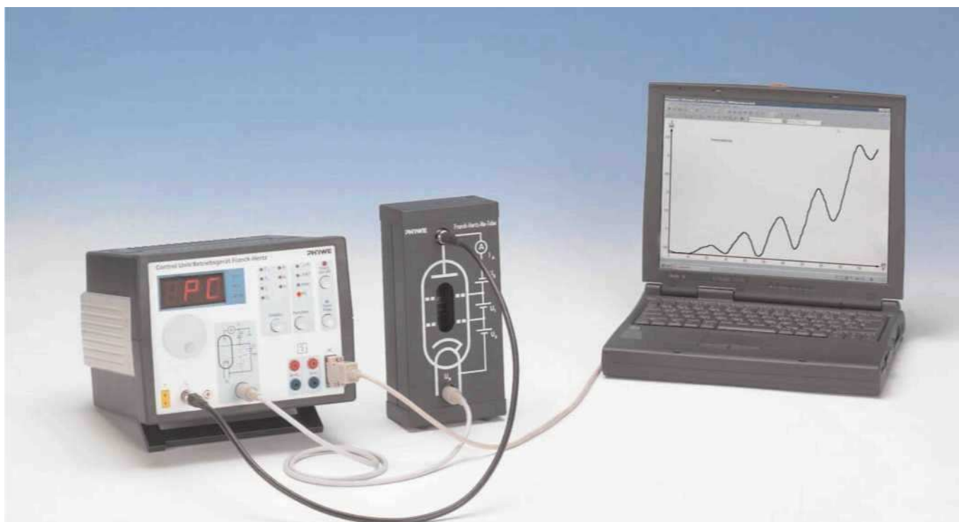
Rys.1 Zestawienie układu do ćwiczenia eksperyment Francka-Hertz'a (przeprowadzanego przy pomocy komputera)
