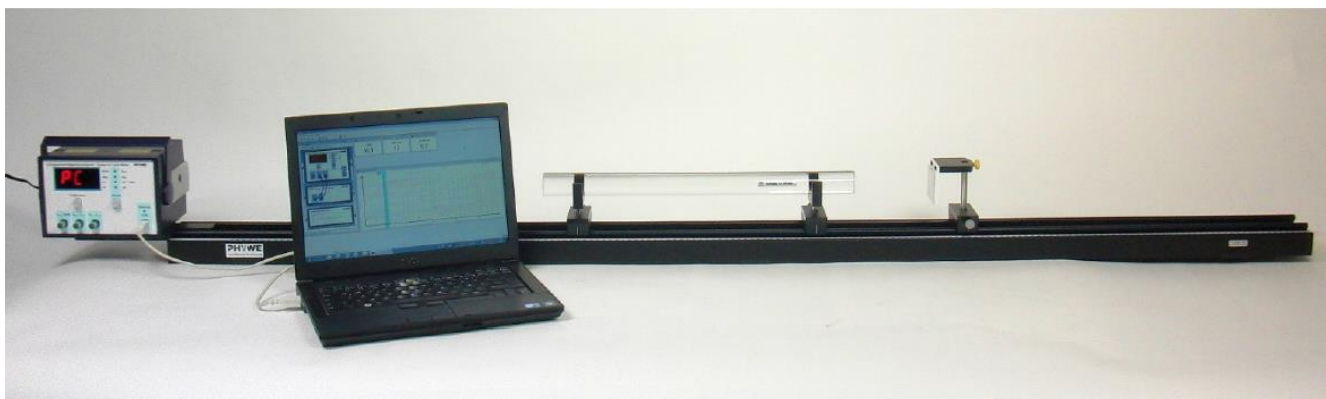
Rys. 1: Zestaw pomiarowy do pomiaru prędkości światła w szkle akrylowym.
