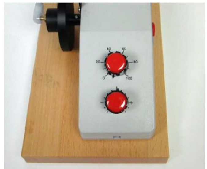
Rys. 5: Pokrętła sterujące silnika. Górne pokrętło: „z grubszą”; dolne pokrętło: „na dokładnie”.
